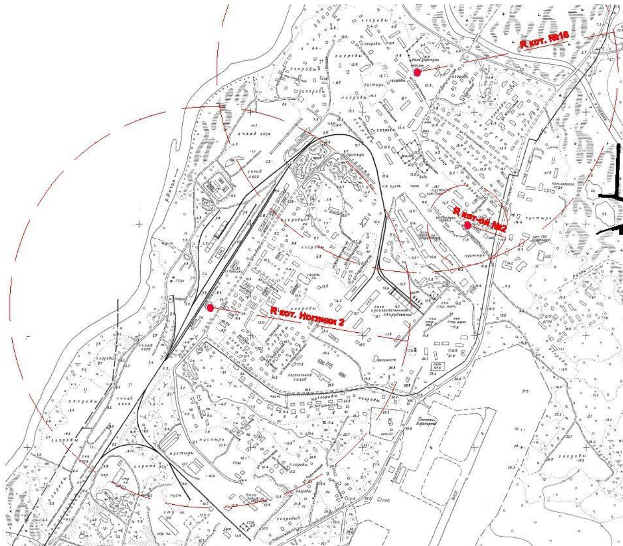
Рисунок 7.3 - Схема административного деления пгт Ноглики (Ноглики-2) с указанием расчетных элементов территориального деления (кадастровых кварталов) и радиусов эффективного теплоснабжения для каждого источника теплоты
