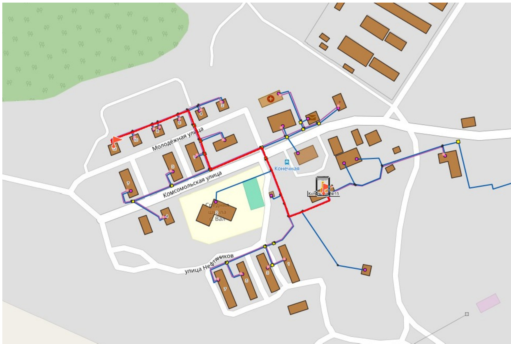
Рисунок 15 - Путь построения пьезометрического графика от Котельной №15 (с. Вал) до определяющего потребителя – Жилой дом (с. Вал, Молодёжная 12)
