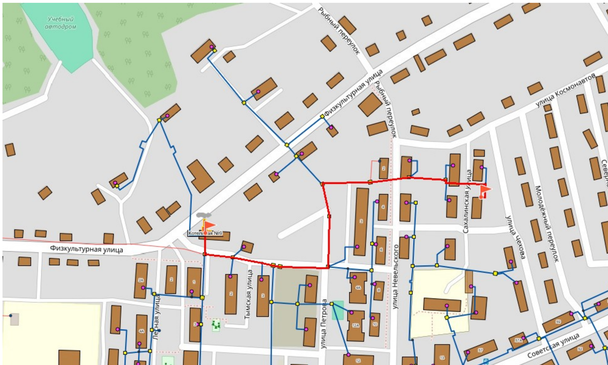
Рисунок 7 - Путь построения пьезометрического графика от Котельной №9 (пгт. Ноглики) до определяющего потребителя – МКД (пгт. Ноглики, ул. Сахалинская, 1)
