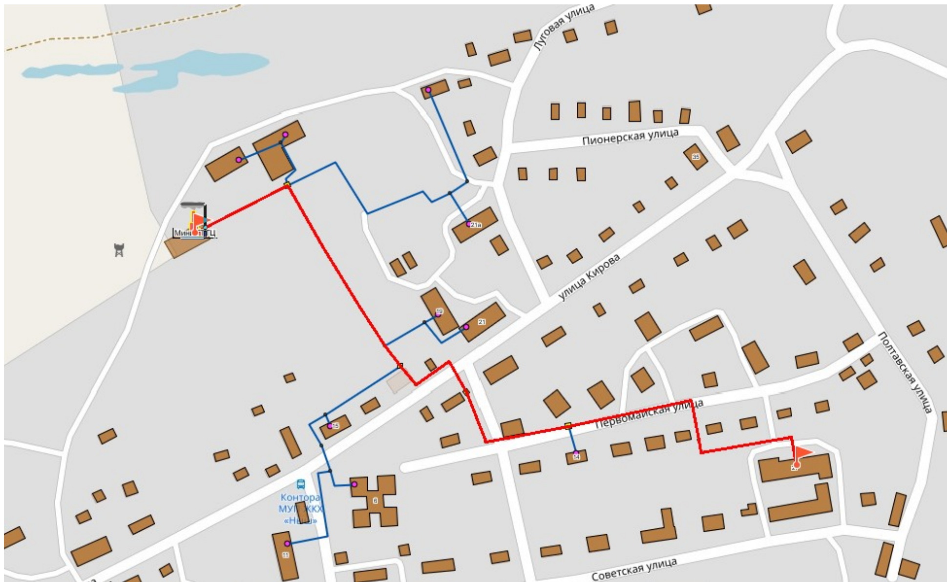
Рисунок 17 - Путь построения пьезометрического графика от Мини ГТ ТЭЦ (с. Ныш) до определяющего потребителя – Школа (с. Ныш)
