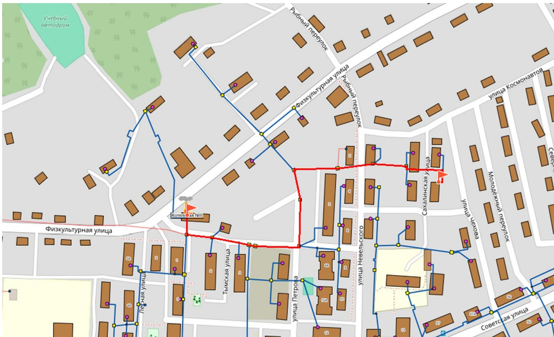
Рисунок 7 - Путь построения пьезометрического графика от Котельной №9 (пгт. Ноглики) до определяющего потребителя – МКД (пгт. Ноглики, ул. Сахалинская, 3)
