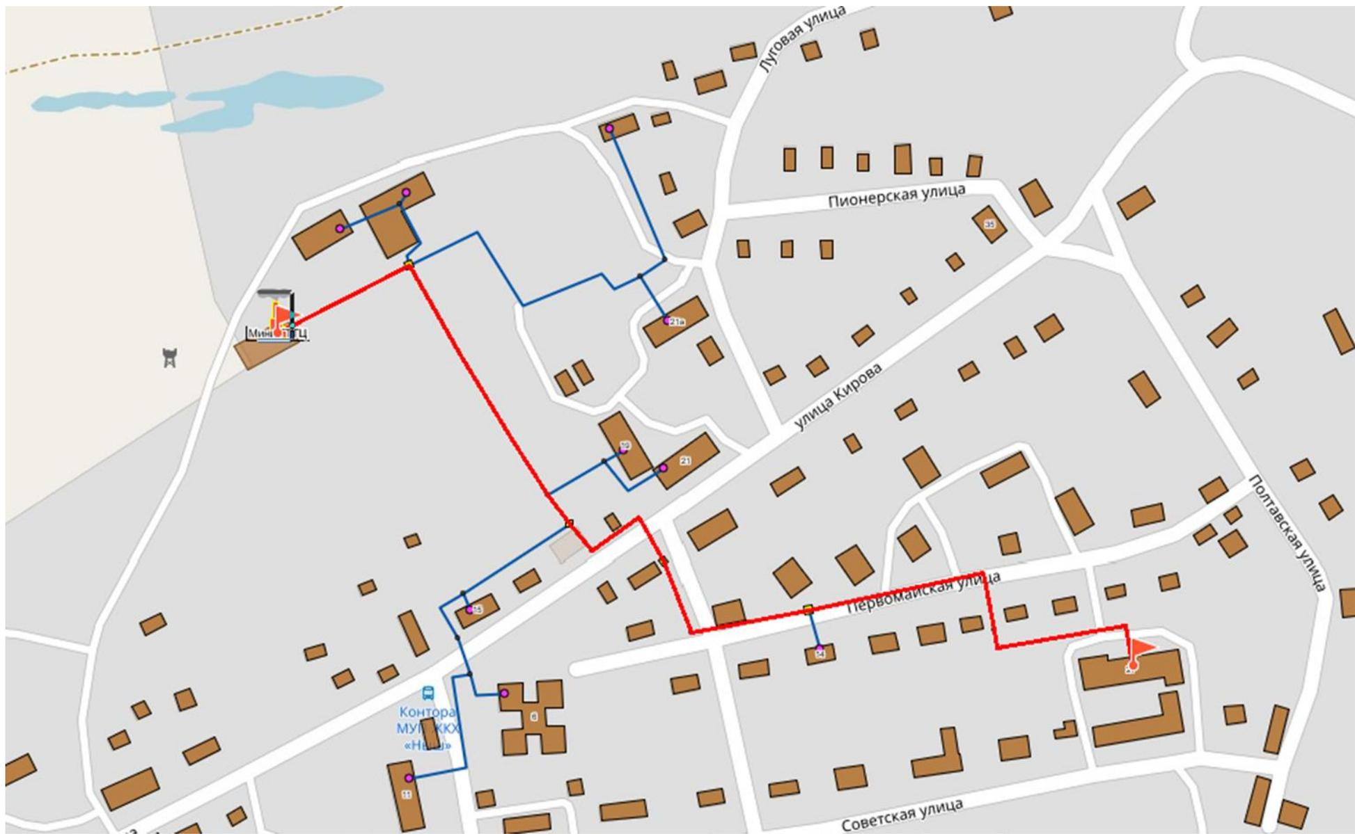
Рисунок 17 - Путь построения пьезометрического графика от Мини ГТ ТЭС (с. Ныш) до определяющего потребителя – Школа (с. Ныш)
