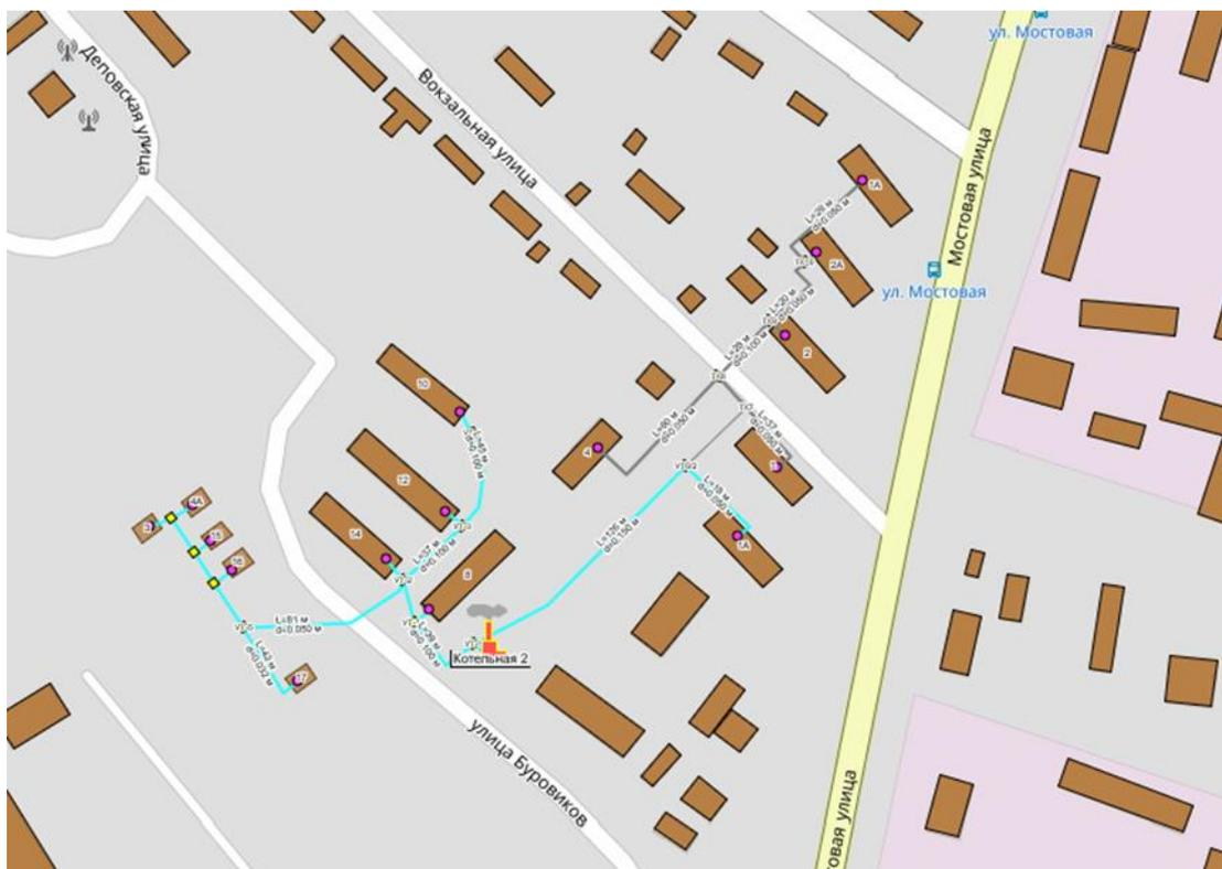
Рисунок 28 – Графическое представление модели системы теплоснабжения Котельной №2 (пгт. Ноглики) при возникновении аварийной ситуации (участки тепловой сети, попадаемые под отключение, изображены серым)
