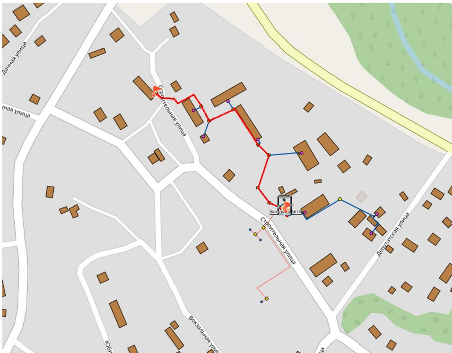
Рисунок 11 - Путь построения пьезометрического графика от Котельной №16 (пгт. Ноглики) до определяющего потребителя – МКД (пгт. Ноглики, ул. Строительная 43)
