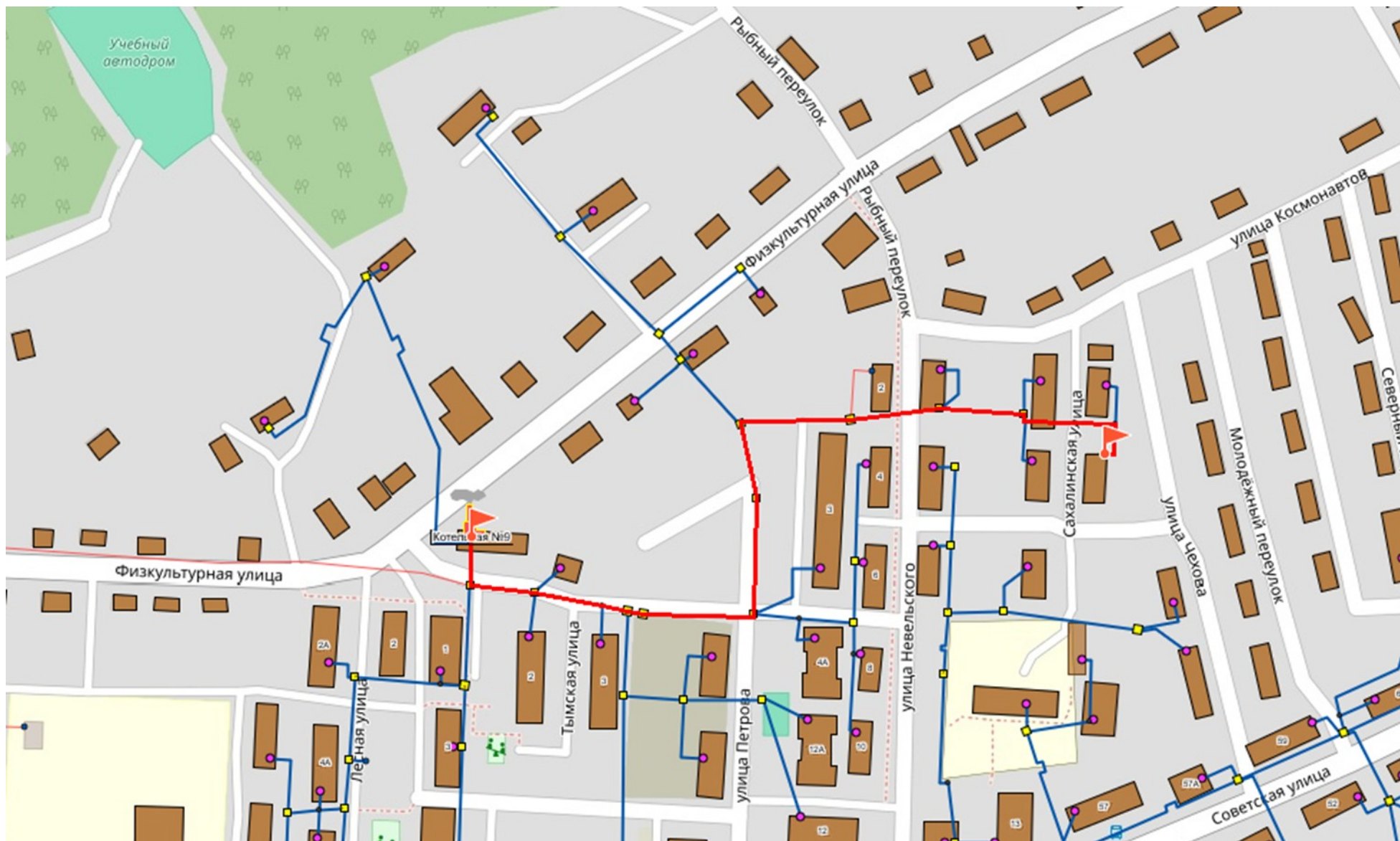
Рисунок 10 – Путь построения пьезометрического графика от Котельной №9 (пгт. Ноглики) до определяющего потребителя – МКД (пгт. Ноглики, ул. Сахалинская, 3)
