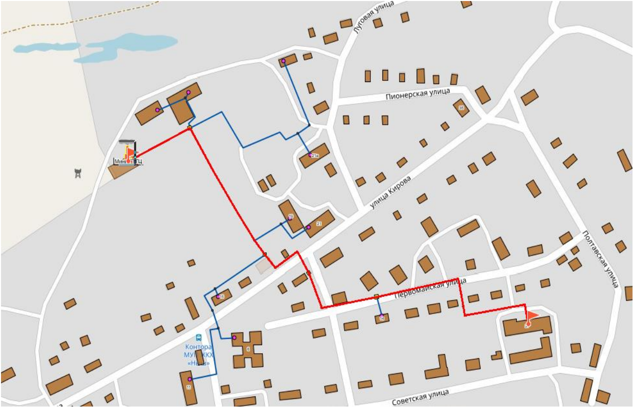
Рисунок 17 - Путь построения пьезометрического графика от Мини ГТ ТЭС (с. Ныш) до определяющего потребителя - Школа (с. Ныш)
