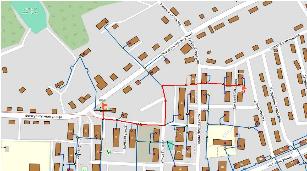
Рисунок 7 - Путь построения пьезометрического графика от Котельной № 9 (пгт. Ноглики) до определяющего потребителя – МКД (пгт. Ноглики, ул. Сахалинская, 1)
