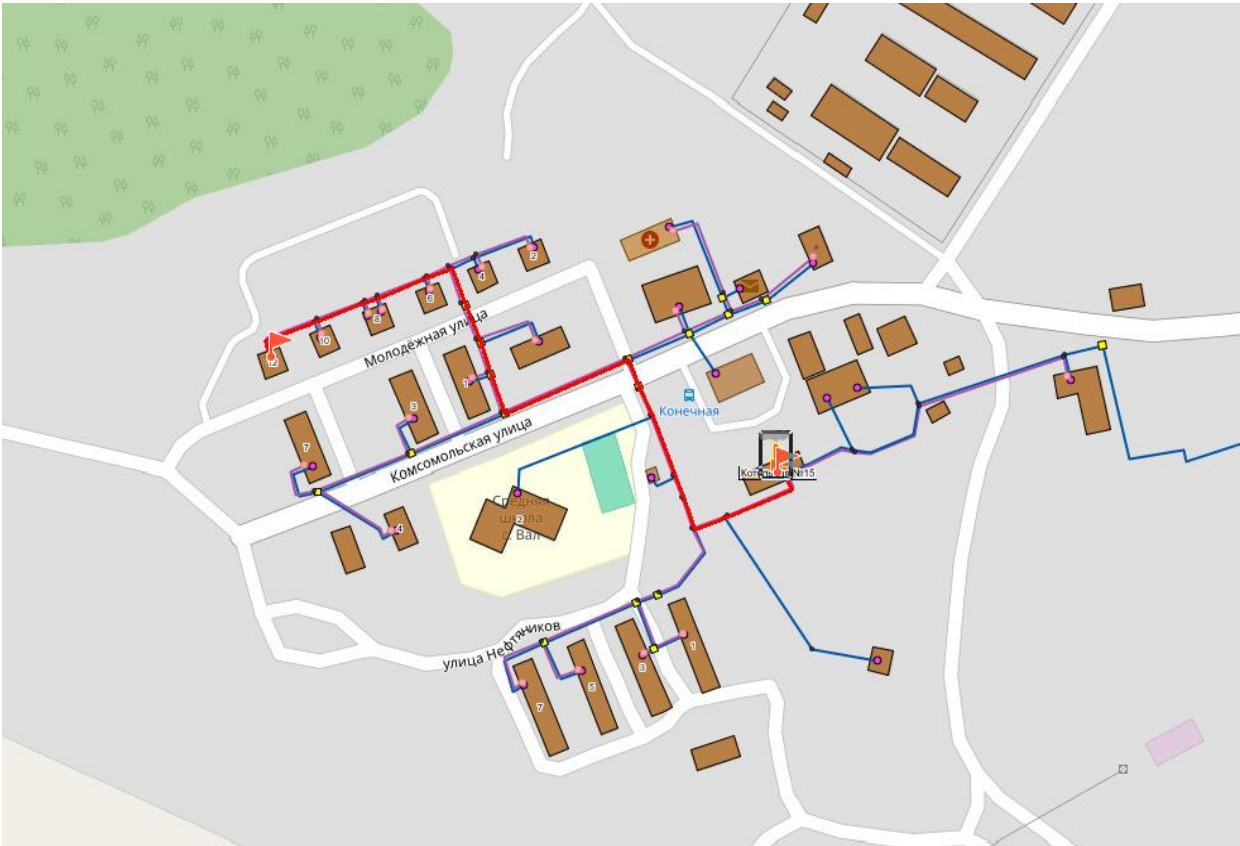
Рисунок 15 - Путь построения пьезометрического графика от Котельной № 15 (с. Вал) до определяющего потребителя - Жилой дом (с. Вал, Молодежная 12)
