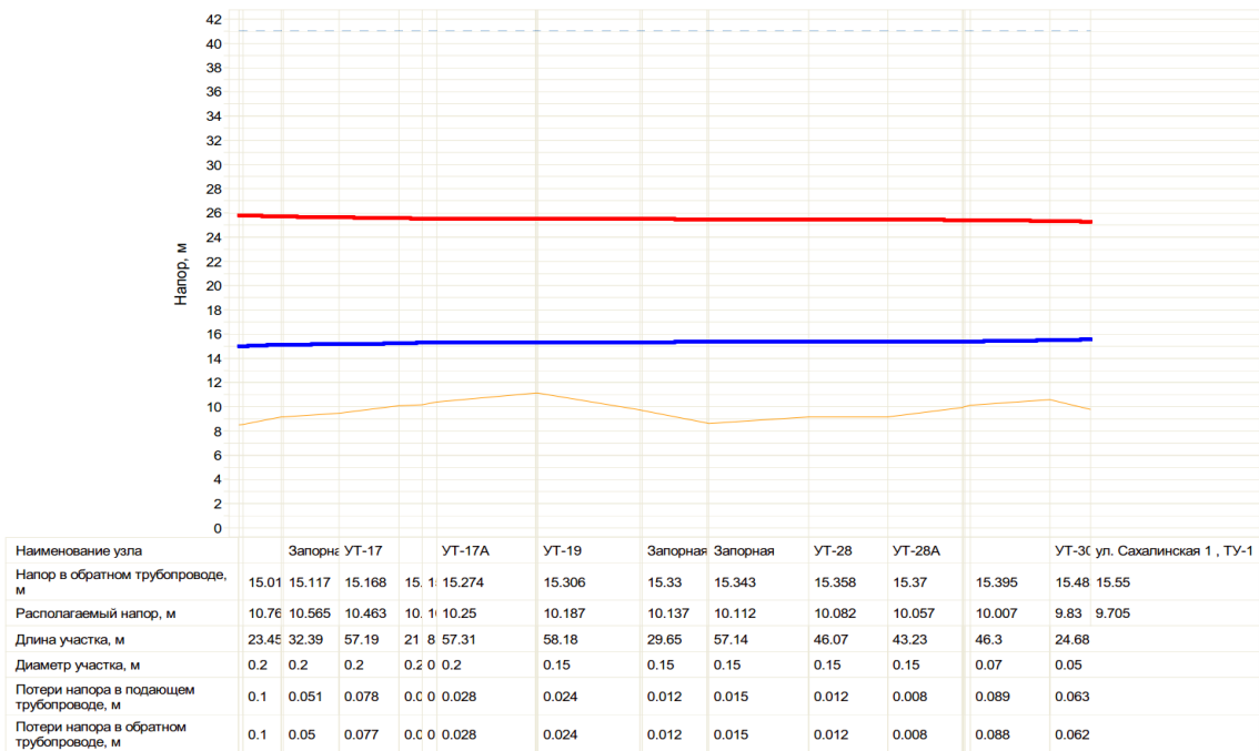
Рисунок 8 - Пьезометрический график Котельной № 9 (пгт. Ноглики) до определяющего потребителя - до определяющего потребителя - МКД (пгт. Ноглики, ул. Сахалинская, 1)
