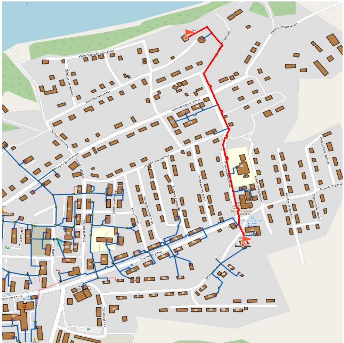
Рисунок 5 - Путь построения пьезометрического графика от Котельной № 5 (пгт. Ноглики) до определяющего потребителя - адм. здание (пгт. Ноглики, ул. Октябрьская 25)
