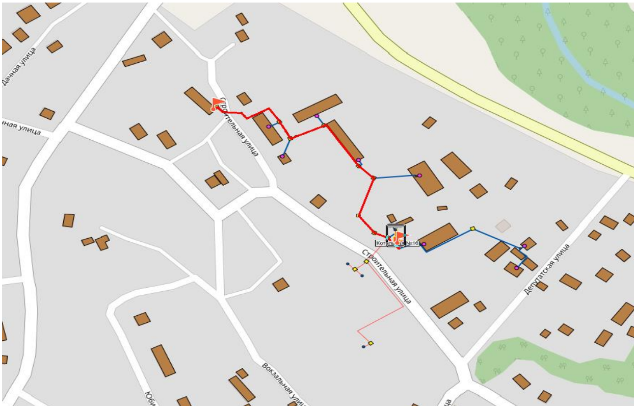
Рисунок 11 - Путь построения пьезометрического графика от Котельной № 16 (пгт. Ноглики) до определяющего потребителя - МКД (пгт. Ноглики, ул. Строительная 43)
