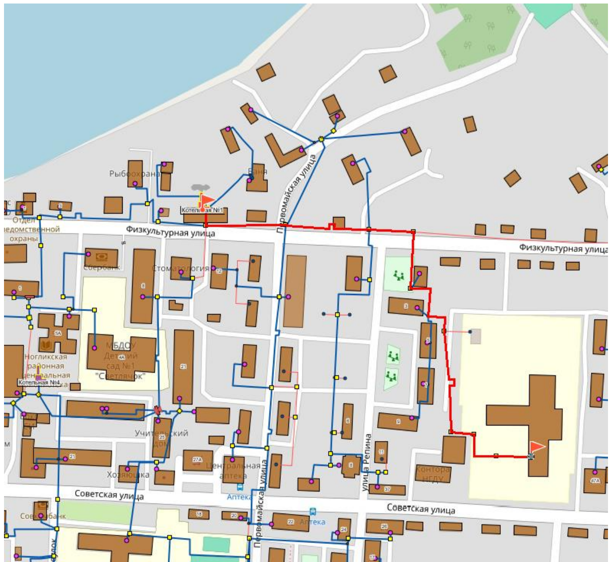
Рисунок 1 - Путь построения пьезометрического графика от Котельной № 1 (пгт. Ноглики) до определяющего потребителя - МБОУ СОШ № 2 (пгт. Ноглики)
