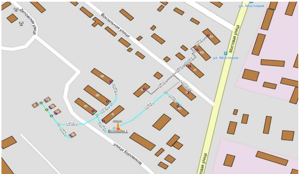
Рисунок 28. - Графическое представление модели системы теплоснабжения Котельной № 2 (пгт. Ноглики) при возникновении аварийной ситуации (участки тепловой сети, попадаемые под отключение, изображены серым)
