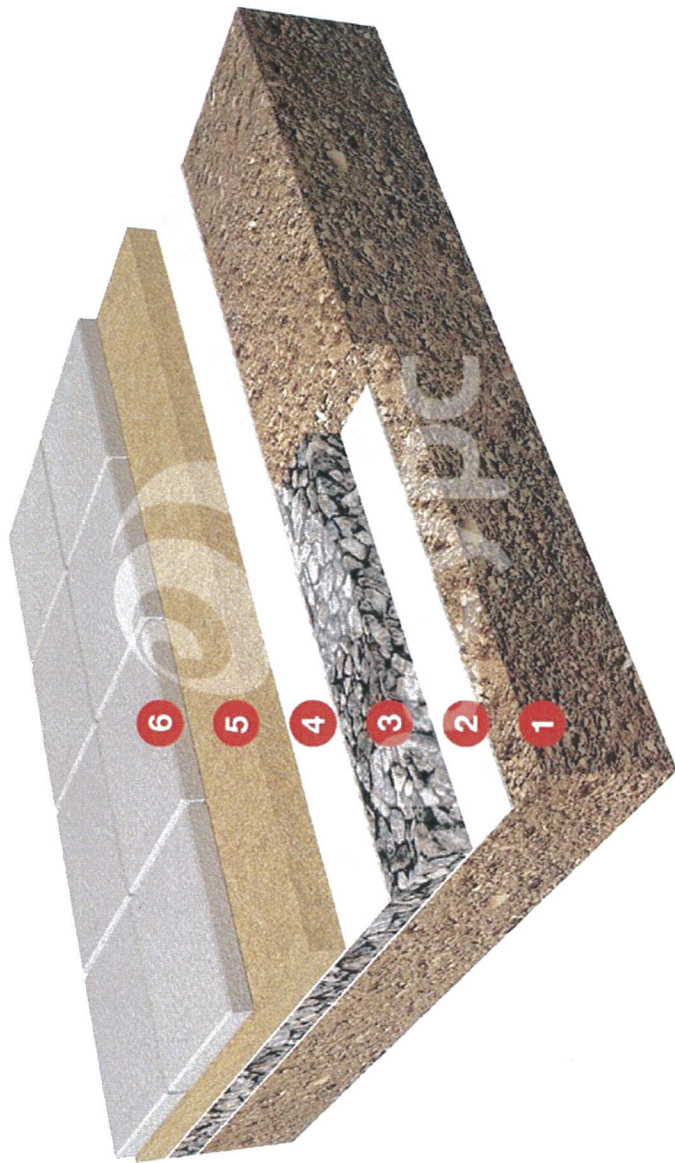
Обустройство дорожек из тротуарной плитки
