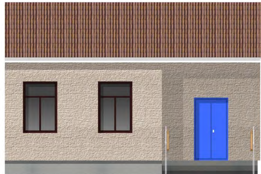
ПЛОХО. Входная дверь не сочетается с окнами и архитектурой жилого дома
