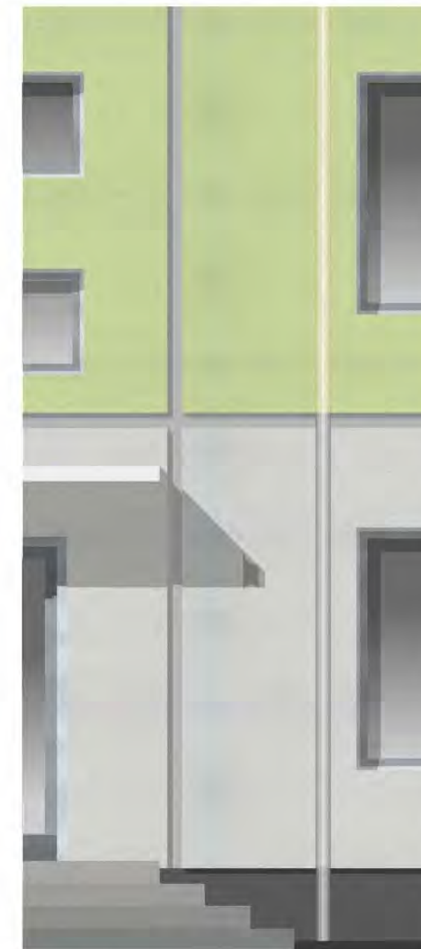
ХОРОШО. Водосточная труба соединена с ливневой канализацией
