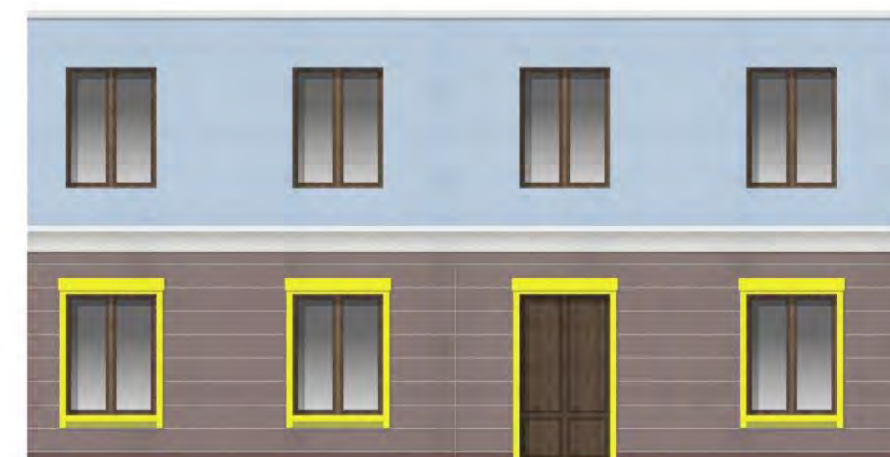
ПЛОХО. Окраска декоративных деталей с нарушением ПЦР
