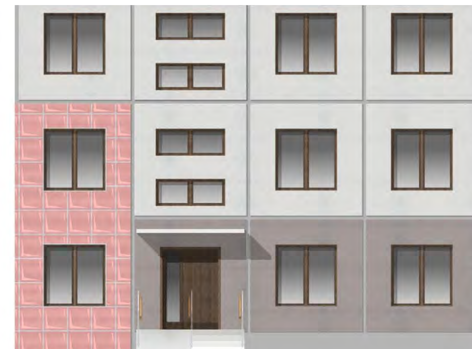
ПЛОХО. Фасад имеет фрагментарную отделку разными материалами
