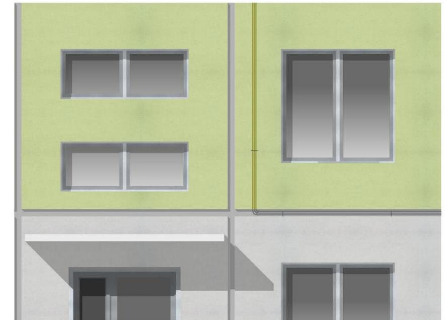
**ХОРОШО.** Инженерные провода упорядочены и выкрашены в цвет фасада
