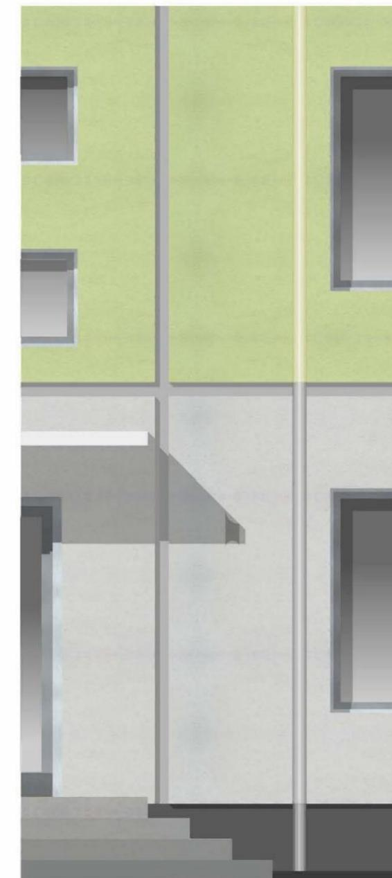
**ХОРОШО.** Водосточная труба соединена с ливневой канализацией
