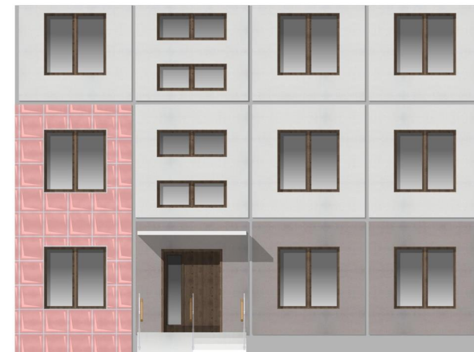
ПЛОХО. Фасад имеет фрагментарную отделку разными материалами
