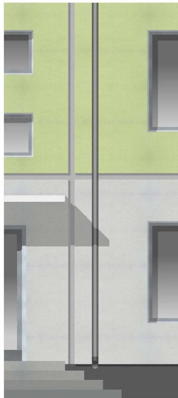
ПЛОХО. Водосточная труба выходит на лестничную площадку
