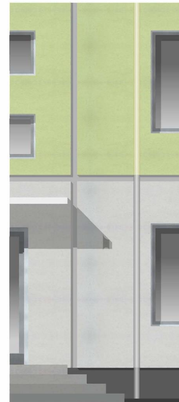
ХОРОШО. Водосточная труба соединена с ливневой канализацией
